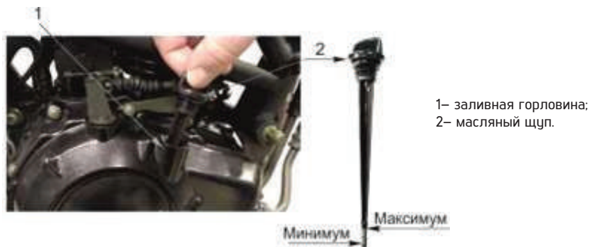
Рисунок 6 – Проверка уровня масла в двигателе
